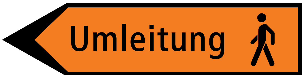
Beispiel Umleitungswegweiser Fussverkehr ohne Zielangabe
